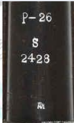
P-26 (of P-27) en S Gevonden op P-series herplaatste lopen. "S" staat voor Salerno alwaar dit proces was ontwikkeld
