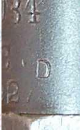
Omgewerkt naar de Finse D166 patroon op loop
