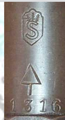
"Kerstboom" op M24 loop Geeft aan dat loop is ingekort vanwege loopmond erosie
