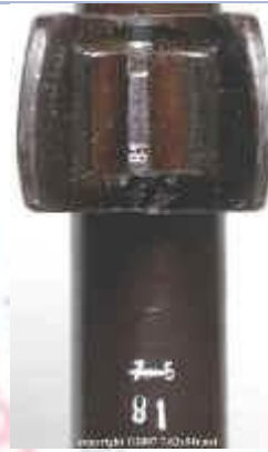
Front sight blade height (0.81cm) Doorgehaald en hernummerd op M39
