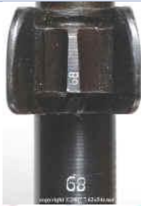
Front sight blade height (0.68cm) Stelt wapenmeester in staat te controleren dat de korrel niet gewijzigd is in het veld. Loop achter front sight M39
